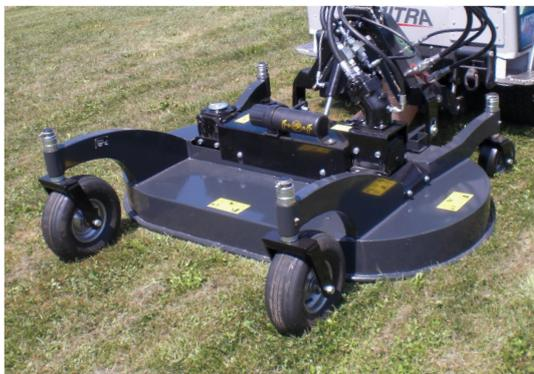
Robust Sichelmäher mit drei leistungsstarken Messern und einer einstellbaren Schnitthöhe von 30–100 mm.
