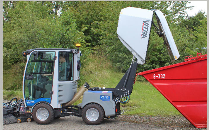
Die Containerentleerung wird direkt aus der Kabine gesteuert. Mit einer Kipphöhe von 175 cm ist es möglich den Sauggutbehälter direkt in einen Abfallcontainer oder Anhänger zu entleeren.
