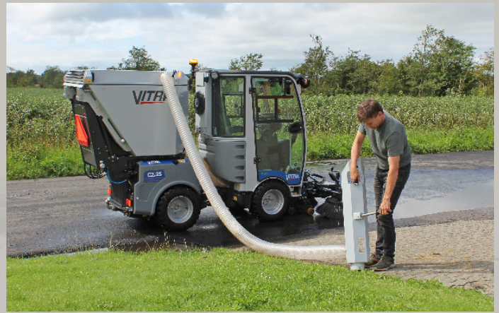
Der externe Saugschlauch ermöglicht eine manuelle Schmutzaufnahme auch in den unzugänglichsten Ecken, da wo das Frontdeck nicht eingesetzt werden kann.
