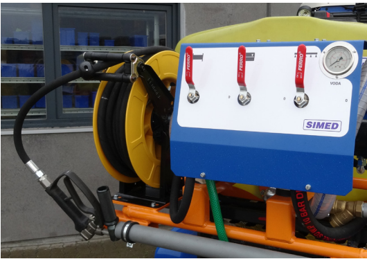
Das System ist mit einem externen Hochdruckreiniger, mit Handlanze und 10 Meter Schlauch ausgestattet.
