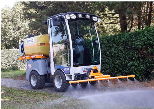
Der 1,3 Meter breite Hochdruckausleger ist mit einem hydraulischen Schwenkwerk und 8 Hochdruckdüsen ausgestattet
