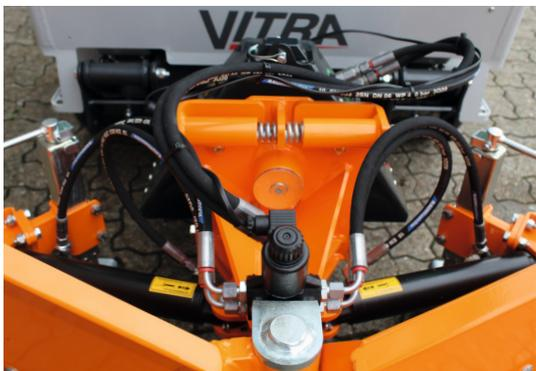
Mit der horizontalen Oszillation wird sichergestellt, dass das Schild an kleineren Hängen und in wechselndem Gelände dem Boden folgt
