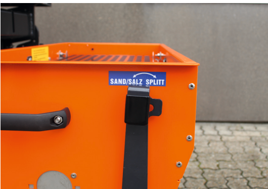
Die Streuer können sowohl mit Sand als auch mit Salz verwendet werden und die Einstellung erfolgt direkt an der Seite des Streuers.
