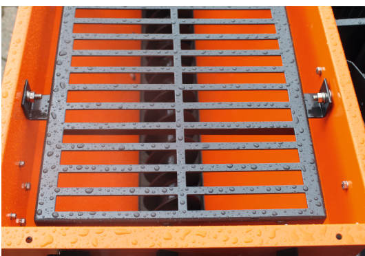
Der Walzenstreuer wird mit einem hydraulischen Umrührwelle geliefert, der eine regelmäßige Streuung des Materials versichert.
