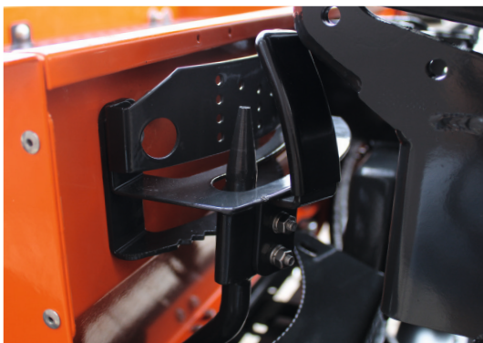
Die Dosierung lässt sich mit eine Hebel, auf der rechten Seite des Streuers, leicht anpassen.
