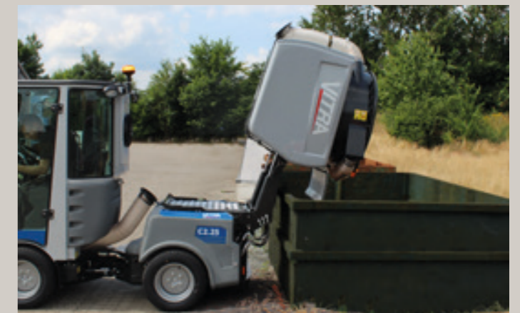
Der Container kann direkt aus der Kabine entleert werden und mit dem 135 cm hohen Kipper kann der Container direkt in einen Abfallcontainer oder Anhänger entleert werden
