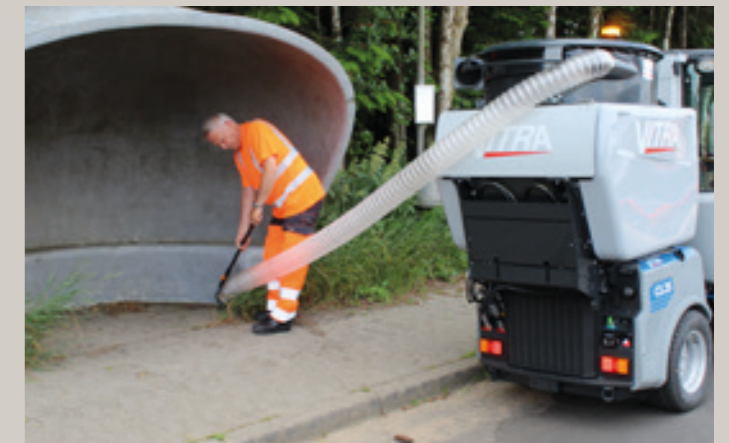
Der externe Saugschlauch ermöglicht eine effektive Reinigung, wo die Maschine nicht gefahren werden kann
