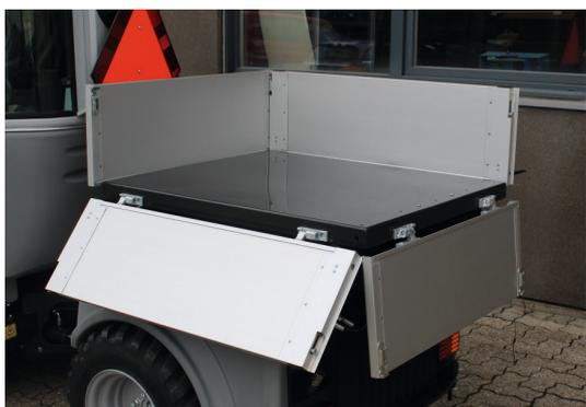
Die pritche ist mit einem flachen Boden und herunterklappbaren Seiten und einer Heckklappe konstruiert.
