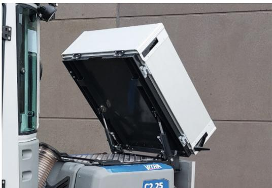
Die pritche kann wahlweise mit hydraulischer Kippfunktion geliefert werden, zum einfachen und schnellen Entladen.
