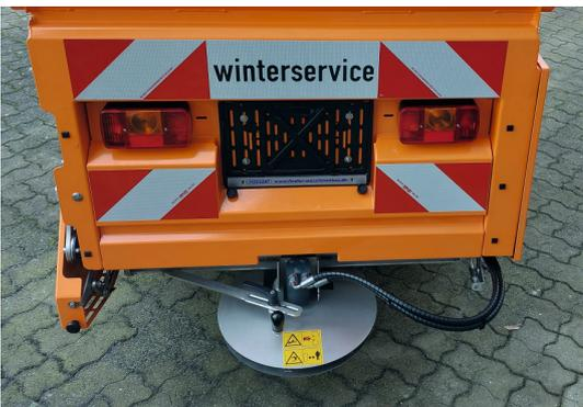
Der Kombistreuer ist für den professionellen Gebrauch gebaut und in Edelstahl und Stahl lackiert mit Korrosionsklasse C5 konstruiert.
