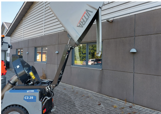
Der Behälter lässt sich bis zu 190cm entleeren, was dem Fahrer viele Entleerungsmöglichkeiten sichert.
