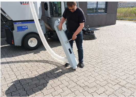
Die Kehrsauganlage ist standardmäßig mit einem praktischen 5 meter Saugschlauch ausgestattet, der Flexibilität verspricht.
