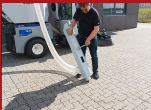
Den 5 meter håndholdt sugeslange giver mulighed for let opsamling, hvor fejesugefronten ikke kan komme til.
