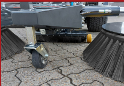
Fejesugefronten er udstyret med en hydraulisk klap, så større mængder løv, eller større affaldsstykker let kan samles op.
