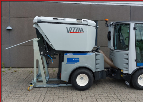
På trods af en container kapacitet på hele 1,5 m 3 af- og påmonteres containeren let med Vitra quick-shift system.
