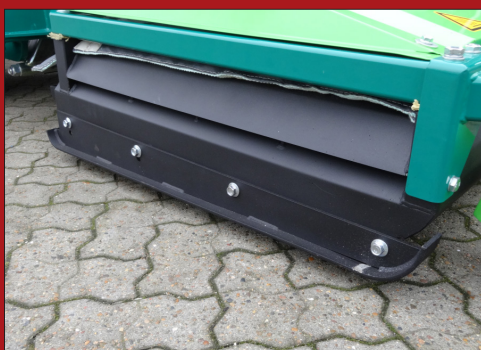
Den innovative sidebrænder, sikrer effektiv bekæmpelse af ukrudt op af fx. husvægge eller kantsten.
