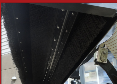
Det specialudviklede sugehoved, opsamler effektivt løv fra banen uden at suge granulater fra bunden af banen med op.
