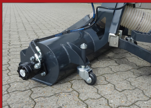
Den hydrauliske drevne valsebørste, jævner nænsomt banens fyldmateriale ud, så banen efterlade pæn og jævn.
