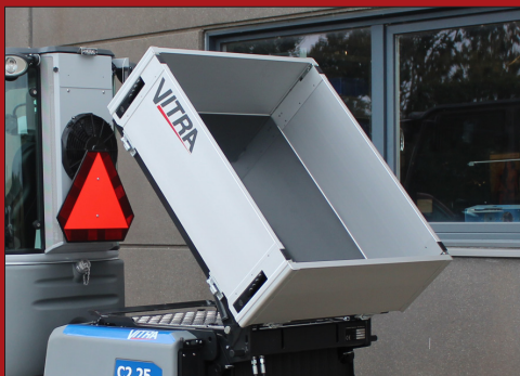
Ladet kan som tilvalg, leveres med hydraulisk tip, hvilket giver mulighed for aflæsning direkte i udvalgte spredeløsninger.
