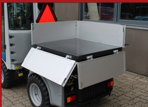
Ladet er forsynet med plan bund og nedfældbare sider og bagklap som også hurtigt kan demonteres helt.
