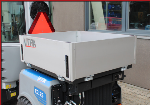
Ladet er opbygget som en stærk stål/alu konstruktion, hvilket sikrer en lav egenvægt og høj lasteevne.
