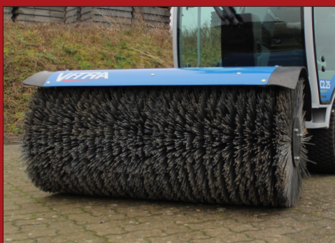
Opdelingen af de to børstevalsehalvdele sparer meget tid ved udskiftning og sikrer en hurtig udskiftning af børsteringe.
