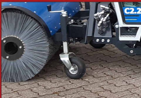
Solidt støttehjul sikre en effektiv og optimal fejning samt sikre, at der sker minimalt børsteslid under brug.
