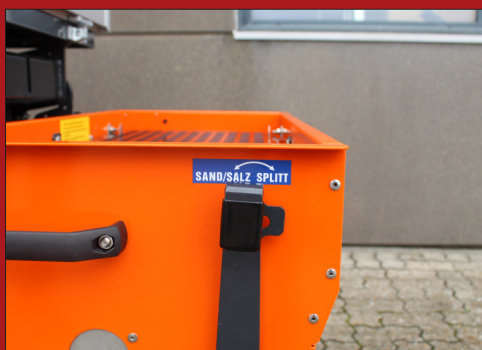
Spredere kan benyttes med både sand og salt og omstilling sker let direkte på siden af sprederen.
