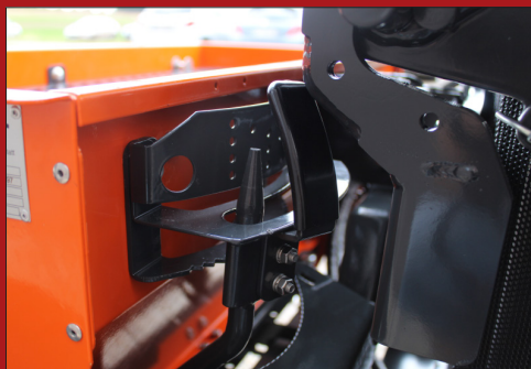
Doseringsmængden justeres let og enkelt ved hjælp af håndtaget, placeret forrest på sprederen.
