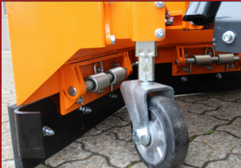
V-plov'en er opbygget med to-delt fjederskær som effektivt sikrer mod påkørsel af ujævnheder i underlaget
