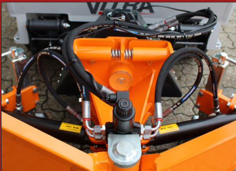
Opbygning med Horisontal pendling sikre at skæret følger underlaget på mindre skrånninger og i vekslende terræn
