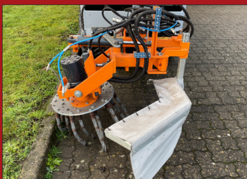
Børsten kan både benyttes på højre og på venstre side af maskinen og drives af en fuld reversibel oliemotor
