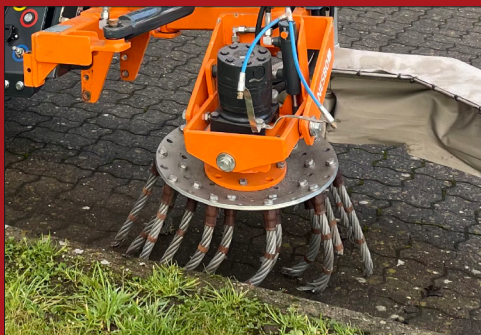
Ukrudtsbørsten er opbygget med hydraulisk tilt, som sikrer en effektiv rensning af ukrudt, selv på ujævne underlag
