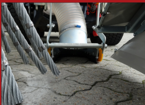
Som option kan ukrudtsbørsten monteres med sugehoved, så den kan kombineres med fejesugeanlæg for let opsamling
