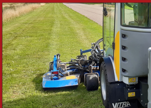
Klipperen leveres som standard med bagudkast men kan som tilvalg også leveres med Bioklipperkit.
