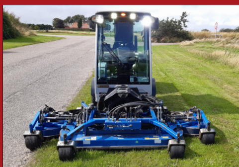
De hydrauliske sidefløje gør, at klipperen, på trods af den store arbejdsbredde, let transporteres rundt i trafikken.
