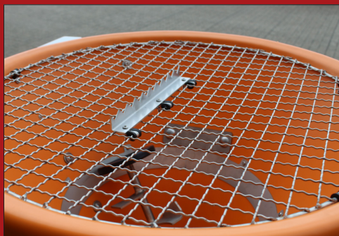
Valsesprederen er udstyret med hydraulisk omrører hvilket sikrer en ensartet udlægning af materialet.
