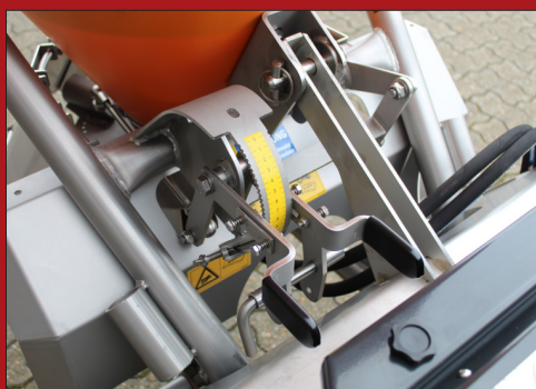
Doseringsmængden justeres let og enkelt ved hjælp af håndtag, placeret forrest på sprederen.
