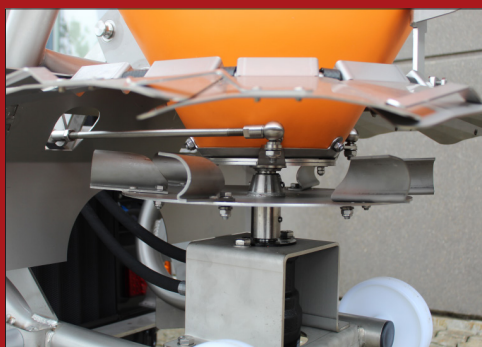
Den rustfri tallerken med justerbare "vinger" og bredderegulering sikrer et perfekt resultat.
