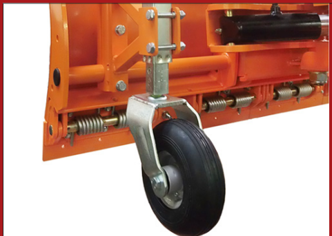
Dozerbladet er monteret på et affjedret ophæng som er opbygget på en standard A-ramme
