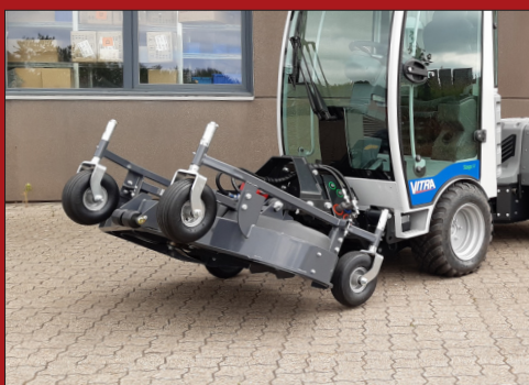
Klippebordene kan let vippes op så rengøring, og vedligehold. Optionalt kan der monteres hydraulisk tilt funktion.
