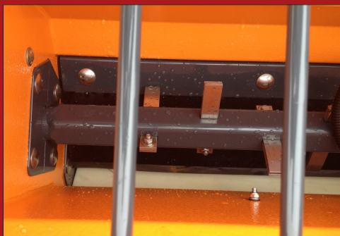
Sprederen er udstyret med rustfri omrører system, som sørger for en ensartet fordeling af spredningsmaterialet.
