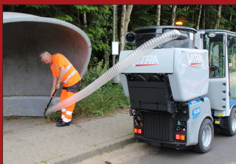
Fejesuge anlægget er som standard udstyret med smart håndholdt suge slange som giver stor fleksibilitet.
