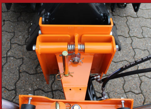
Doozerbladet er opbygget med selv centrerende horisontal pendling, som sikrer dozerbladet mod påkørsel
