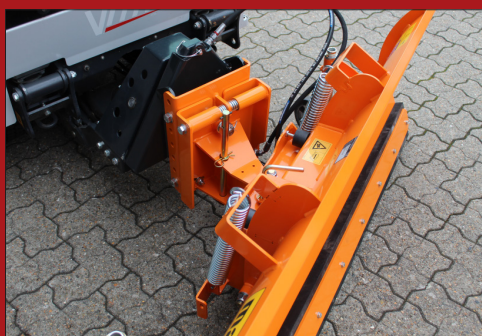
Hydraulisk vinkeljustering af dozerbladet giver mulighed for op til 25 grades justering til hver side, direkte fra kabinen
