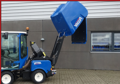
Der Behälter lässt sich bis zu 190cm entleeren, was dem Fahrer viele Entleerungsmöglichkeiten sichern.
