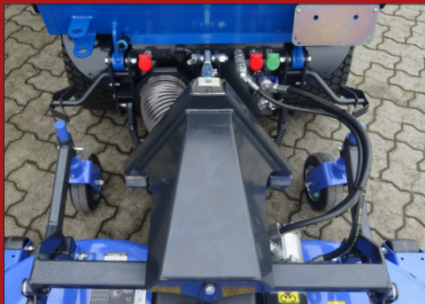
Das Mähdeck wird mit einem Standard A-Rahmen und mit kräftigen Stützrädern montiert.
