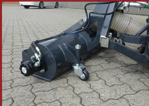
Die hydraulisch betriebene Walzenbürste ebnet langsam das Füllmaterial des Platzes, sodass er schön gerade hinterlassen wird.
