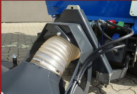
Die Front ist mit einem Standard A-Rahmen - Kat.0 gebaut und kann deshalb an vielen verschiedenen Maschinen angebracht werden.
