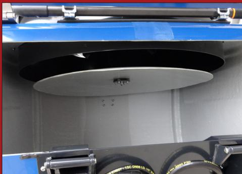
Vitras Kehrsauganlage nutzt ein einzigartiges Zyklonfiltersystem, das nicht verstopft und die Luft aktiv säubert.
