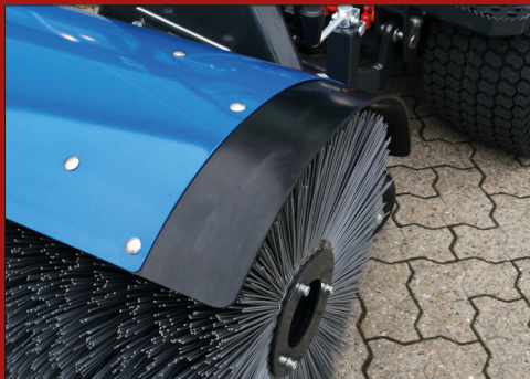
Die Bürstenabdeckung ist zum Teil aus Kunststoff, um Anfahrt Schäden zu vermeiden.
