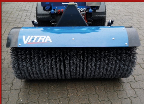
Der Aufbau sichert schnelle und einfache Austausch von Bürstenringe.
