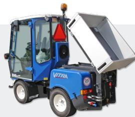
Die pritche kann wahlweise mit hydraulischer Kippfunktion geliefert werden, sodass die Lade z.B. dazu genutzt werden kann, Streumaterial schnell aufzufüllen oder einfach ein unbeschwertes Abladen zu gewährleisten.
