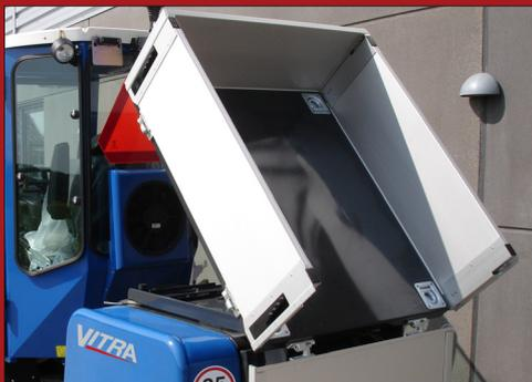
Optional kann die pritche mit hydraulischen kippfunktion geliefert werden, so dass das Abkippen direkt von der Kabine aus erfolgen kann.
