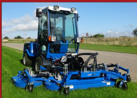
Der Mäher Kommt standardmäßig mit Hintenauswurf aber kann optional mit einem Bioclip-Kit geliefert werden.
