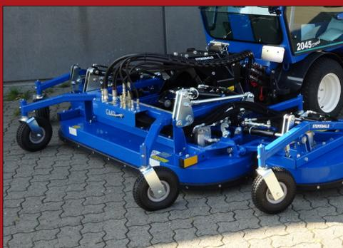
Die kräftige Rahmenkonstruktion ist mit einer flexiblen Aufhängung auf einen Car.1 A-Rahmen angebracht
