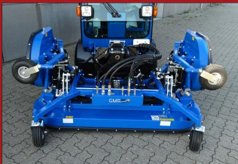
Die hydraulischen Seitenflügel sorgen dafür, dass der Schneider trotz seiner Größe leicht im Straßenverkehr transportiert werden kann.
