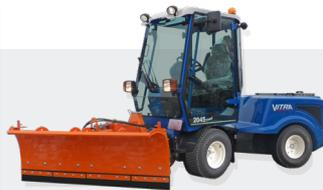
Der Schneeschilt wird serienmäßig mit einer hydraulischen Lenkung geliefert, sodass der Winkel des Besens direkt von der Kabine aus angepasst werden kann.
