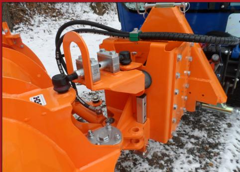
Der Schilt ist an einer abgedrehten Aufhängung angebracht, die auf einem standard A-Rahmen montiert ist.
