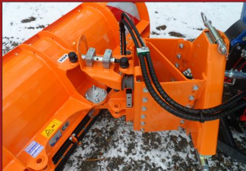
Der Schilt ist standardmäßig mit hydraulischer Schwenkung ausgestattet.
