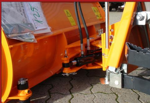
Hydraulisches schwenken direkt von der Kabine versichert optimale Winkelanpassung an die Arbeitsverhältnisse
