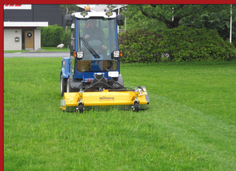
Mit einer breiten Auswahl an Messern, kann der Mäher auch für normales Mähen großer Grasflächen genutzt werden.
