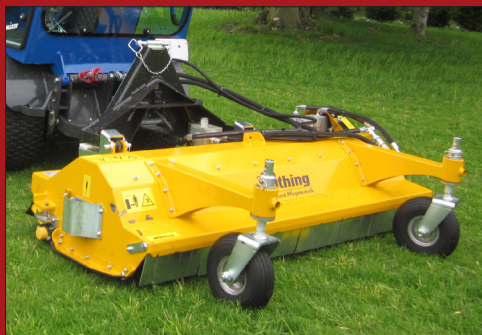
Der Mäher ist mit schwebender Aufhängung gebaut und mit höhen verstellbaren Räder vor dem Mäher ausgerüstet.
