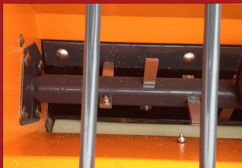
Der Streuer ist mit umrührwelle in Edelstahl ausgerüstet, der für eine gleichmäßige Verteilung des Materials sorgt.
