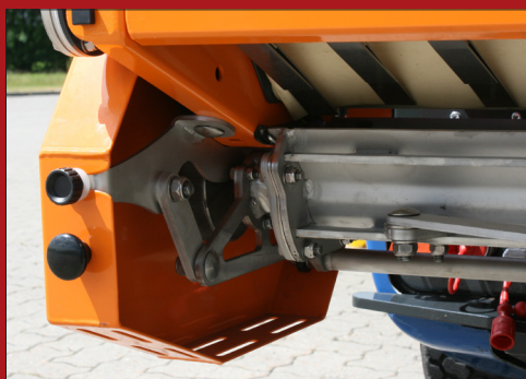
Der Wechsel zwischen Walzen- und Tellerstreuung geht leicht von der Kabine aus, wo auch die Streubreite leicht anzupassen ist.
