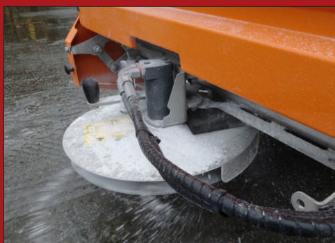
Alle Teile des Streuers sind entweder Edelstahl oder mit Lack der Korrosionsklasse C5 lackiert.
