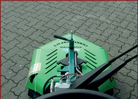
Den kompakte opbygning giver en egenbrede på kun 75 cm. hvorved enheden kan komme til på meget smalle passager.
