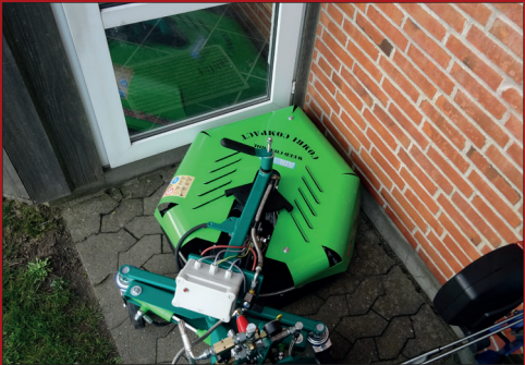
Med det svingbare brænderhovede er det muligt at bekæmpe ukrudt helt ind i hjørner mellem fx. bygninger.
