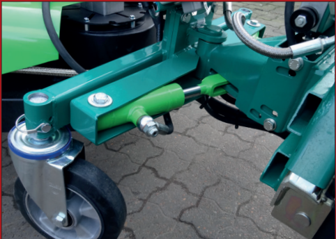
Enheden er hydraulisk svingbar til begge sider, hvilket nemt og bekvemt styres direkte fra kabinen.
