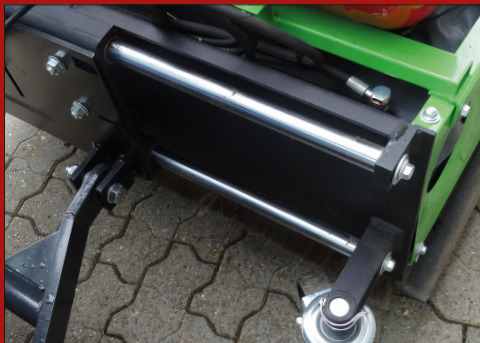
Anlægget kan leveres med hydraulisk sideforskydning, som giver mulighed for at sideforskyde 180 mm. til hver side
