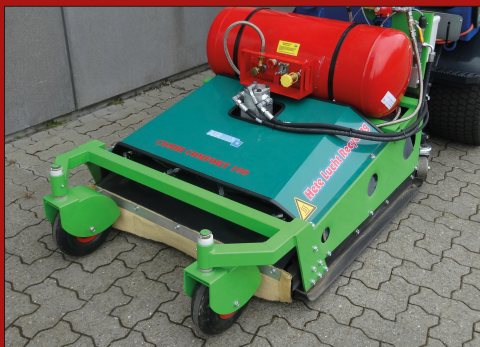
Systemets totalvægt, inkl. maskine og gas, er på kun 1700 kg. og giver derfor minimal belastning af underlag
