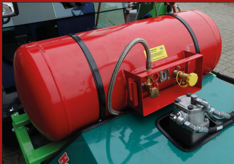
Systemet kan leveres med 85 ltr. tanksystem, som giver gas nok til, op til 2 dages arbejde, uden påfyldning.
