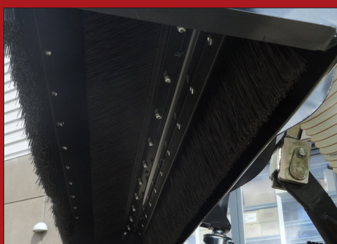
Det specialudviklede sugehoved, opsamler effektivt løv fra banen uden at suges granulat fra bunden af banen med op.
