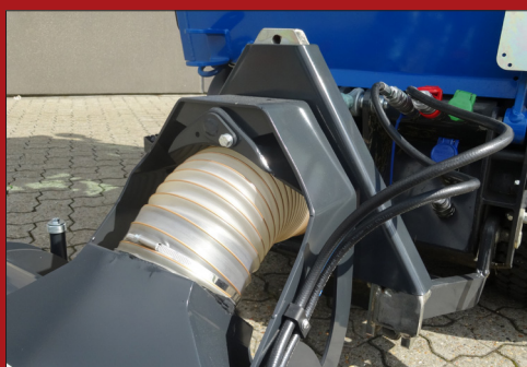
Fronten er opbygget med standard A-ramme - Kat.0 og kan således monteres på et væld af forskellige maskiner.
