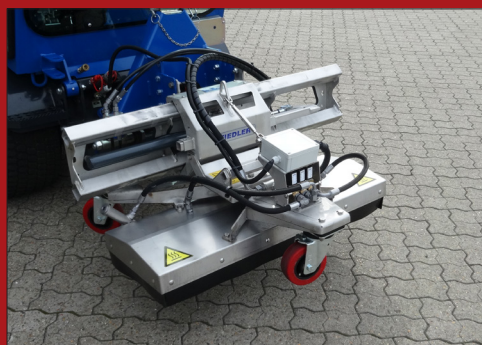
Frontenheden leveres med hydraulisk sideforskydning og er segmentopdelt i 2 x 50 cm. Som tilvalg fås sidebom
