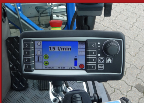
Styring af vandmængde, temperatur, og kørselshastighed sker let og bekvemt fra styringens store farvedisplay
