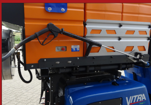
HW100 kan som tilvalg udstyres med praktisk håndholdt lanse med 15m. slange, til effektiv bekæmpelse i fx. kælderskakter
