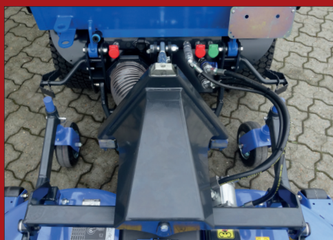
Klippebordet monteres med standard A-ramme og er forsynet med kraftige støttejul
