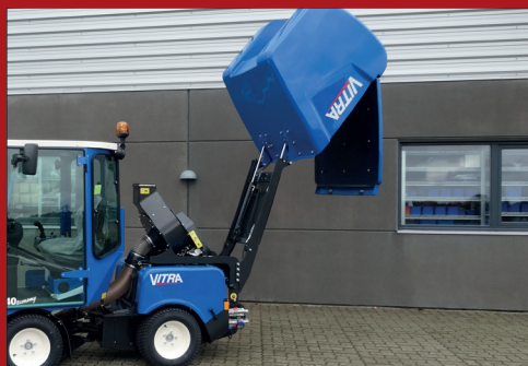
Containeren kan tømmes i hele 190 cm, hvilket sikre chaufføren et væld af aftipnings muligheder
