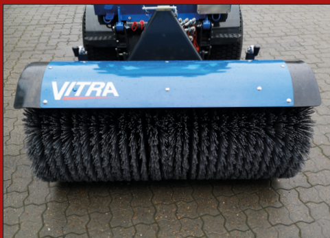
Opdelingen af de to børstevalsehalvdele sparer meget tid ved udskiftning og sikrer en hurtig udskiftning af børsteringe.
