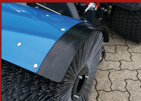
Børste afskærmningen er forsynet med gummikanter som sikrer mod skader ved en eventuel påkørsel.
