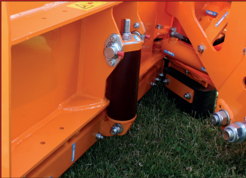
Det fjedersikrede skær er sektioners opdelt, så kun den del som møder en forhindring, vipper væk
