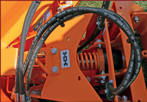
V-ploven er opbygget med horisontal flex-affjedret ophæng, som sikre at mod direkte påkørsel
