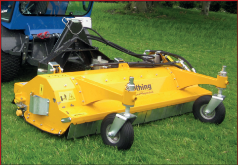
Klipperen er opbygget med flydendeophæng og er udstyret med justerbare højdehjul foran klipperen.
