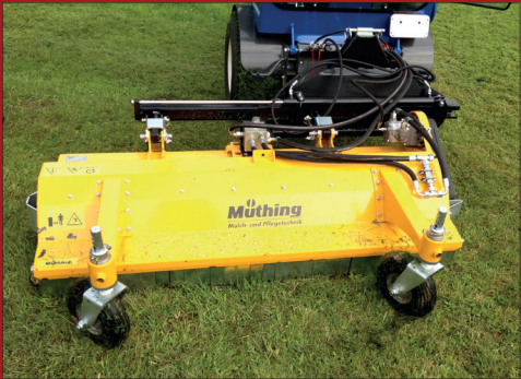
Som tilvalg kan klipperen leveres med hydraulisk styret sideforskydning, som giver ekstra stor fleksibilitet.
