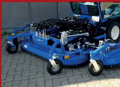
Den kraftige rammekonstruktion er monteret med fleksibelt ophæng, monteret på en Cat.1 A-ramme.
