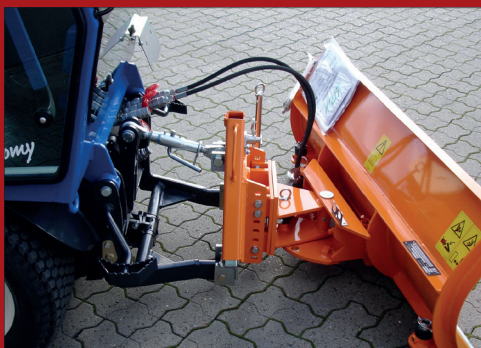
Doozerbladet er tilpasset Vitra og opbygget med klapskærret som sikrer mod påkørsel
