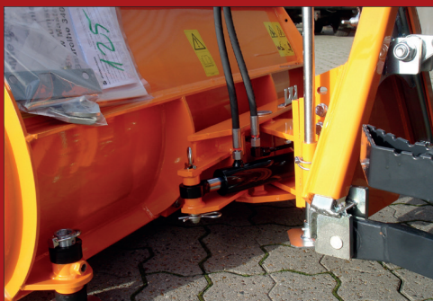
Hydraulisk sving sikrer optimal vinkling i forhold til arbejdsforholdene
