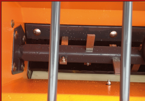
Sprederen er udstyret med rustfrit omrører system, som sørger for en ensartet fordeling af spredningsmaterialet.
