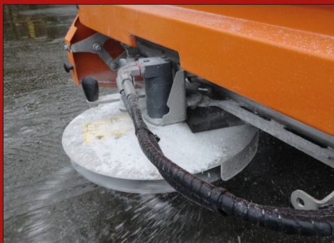
Alle dele på sprederen er enten udført i rustfrit stål eller lakeret med lak i korrosionsklasse C5.
