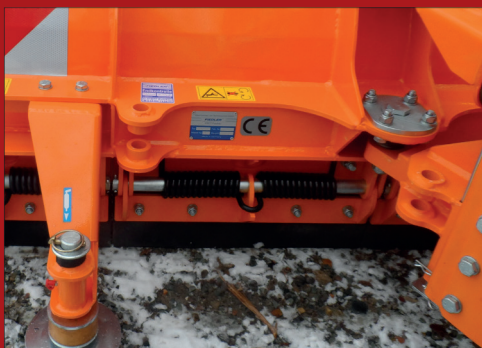
Det sektionens opdeltede klapskær sikrer at skæret klapper væk hvis det møder en forhindring i underlaget
