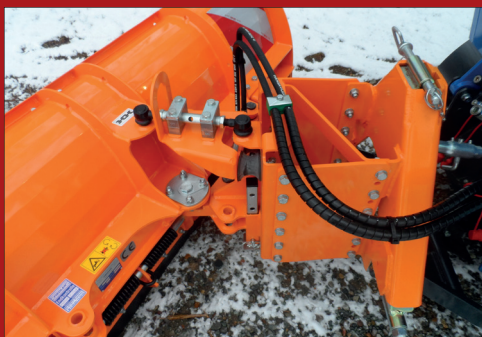
Doozerbladet er som standard monteret med hydraulisk justering af arbejdsvinklen
