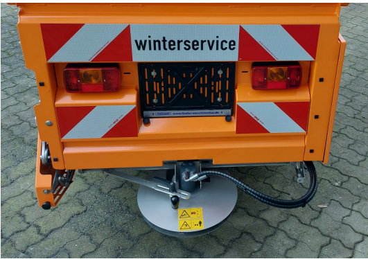
Alle dele er fremstillet af enten rustfritstål eller lakeret med lak i C5-korrosionsklassen hvilket sikrer sprederen en lang levetid.
