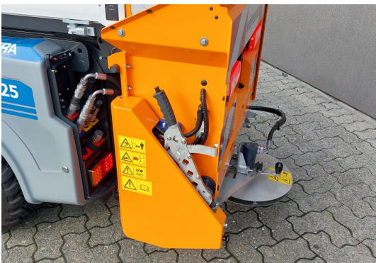
Skift mellem valse- og tallerkenspreder sker let og komfortabelt, direkte fra kabinen og som tilvalg fås kørselsautomatik.
