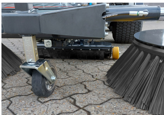
Der breite Saugkopf ist mit einer hydraulischer Klappe ausgestattet, für aufnahme von Laub und großschmutz.
