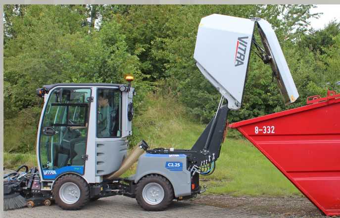
Kontener opróżnia się bezpośrednio z kabiny, a dzięki wysokości rozładunku 175 cm opróżnianie może odbywać się bezpośrednio do kontenera na odpady lub przyczepy.
